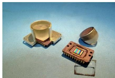
繊細なボンドワイヤをカプセル化し、厳しい環境条件に適合させます。
